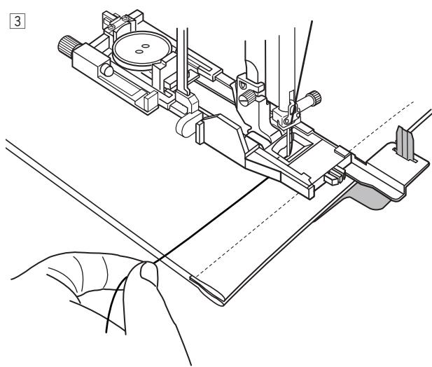
3 Placez le tissu entre le pied de la boutonnière et la plaque stabilisatrice. Abaissez l'aiguille dans sa position de départ en tournant le volant.
