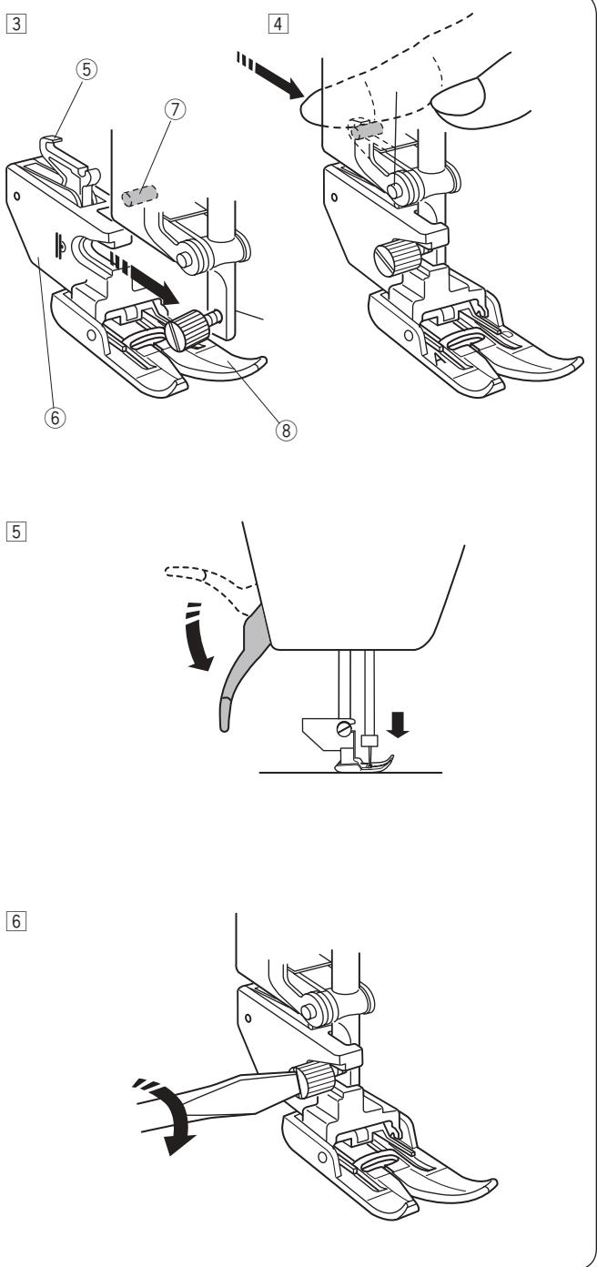
3 Attachez le pied à double entraînement à la barre d'appui. Serrez la vis de fixation doucement avec votre doigt.
