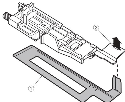
1 Insérez l'onglet de la plaque stabilisatrice ① dans l'encoche ② du pied pour boutonnière.
