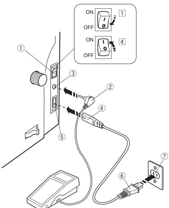
Si vous souhaitez utiliser la pédale de commande, insérez le connecteur à broches dans la prise de la machine.
