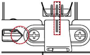
Installez correctement l'attachement sur la machine tel qu'illustré ci-dessus.
