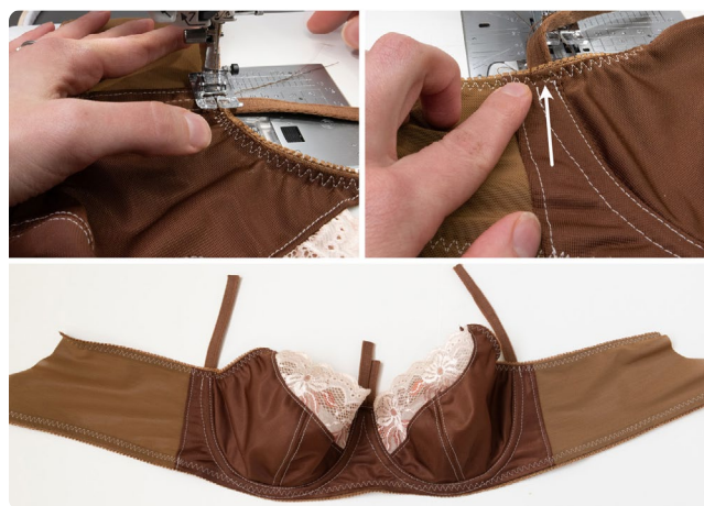
» Figure 32 : Renforcement du sous-bras pour sécuriser l'armature
