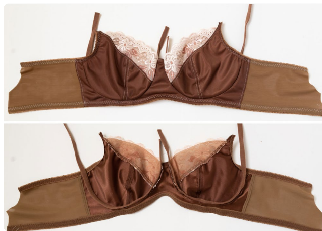
» Figure 28 : Les extrémités de l'élastique en excès sont coupées après le second passage des élastiques de la bande supérieure et inférieure
