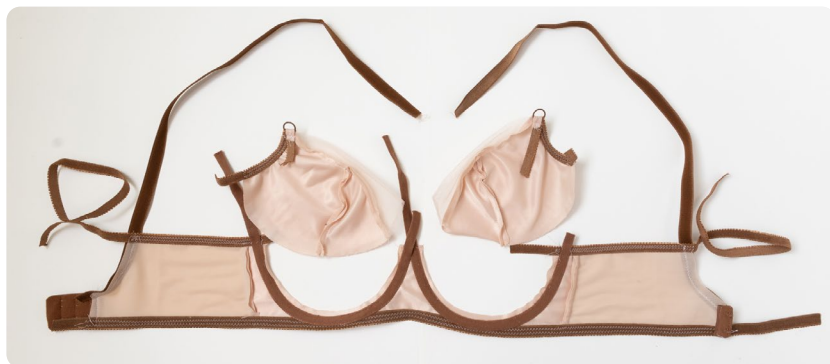
Un prototype de soutien-gorge avec bonnets et bande de base cousus et finis séparément ; les élastiques en excès ne sont pas coupés ; ils sont cousus avec du fil soluble pour un démontage facile.
